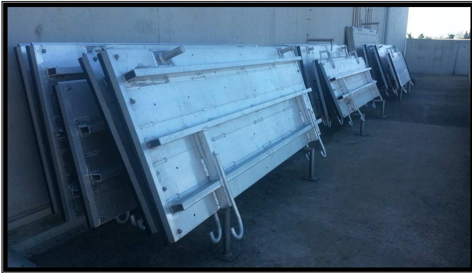
Nouveau jeu de batardeaux pour isoler les cellules de biofiltration.
