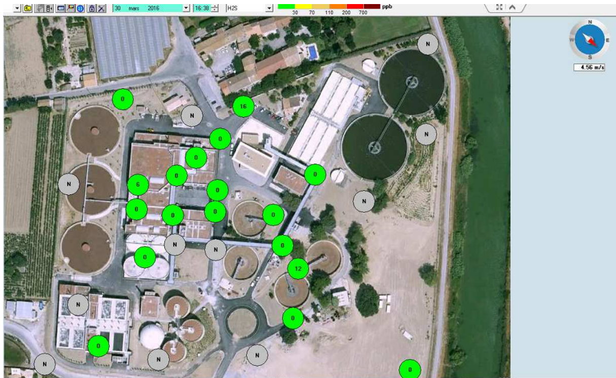
Réseau des 29 capteurs repartis sur le site de la Step MAERA qui mesurent l'H2S en temps réel pour mise à jour de la carte toutes les 15 minutes
