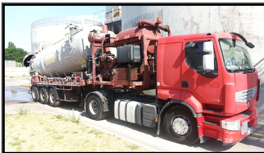
Pompage des billes Biostyr depuis la bêche à eaux sales.
