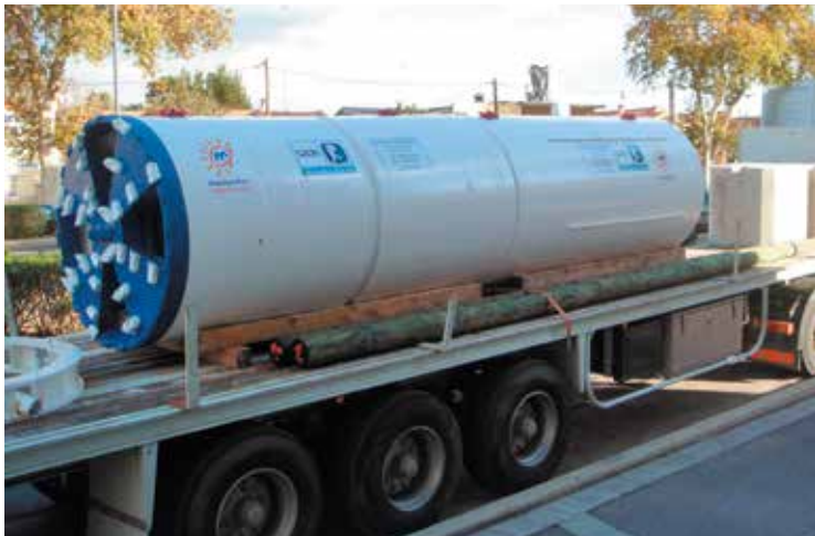
L'un des deux micro-tunneliers qui passera sous l'avenue de la Pompignane.
