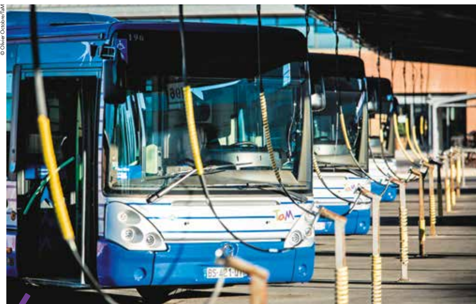
Les bus roulant rechargés au gaz naturel sur les sites de TaM offrent de nombreux avantages par rapport aux modèles diesel.
