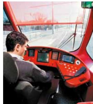
Depuis leur cabine de pilotage, les conducteurs peuvent déposer du sable sur la voie afin de favoriser l'adhérence de la rame dans les fortes pentes.
